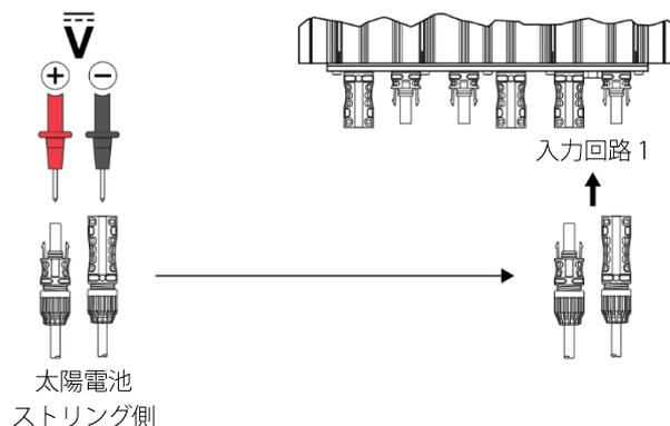
2. 太陽電池ストリングの電圧と極性を確認して、入力2を接続してください。
