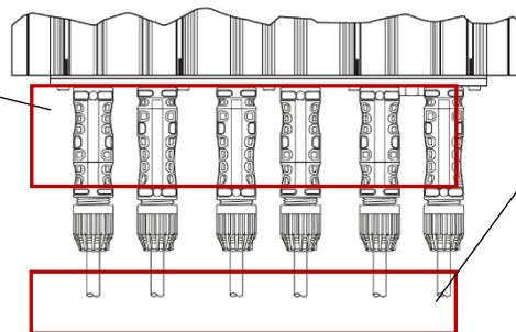
コネクタに横方向の負担がかからないようにケーブルを接続してください。また、接続したケーブルが常に動かないようにしてください。インラインヒューズを使用する場合、および/またはトラック一架台に取り付ける場合は、特に注意してください。
