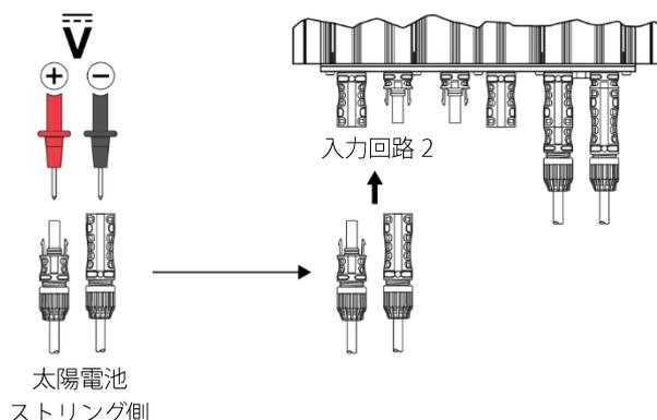
3. 出力電圧を確認して、出力を接続してください。
