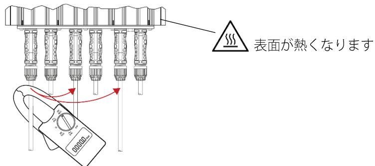
図 20: オプティマイザ回路に電流が流れていなことを確認します
