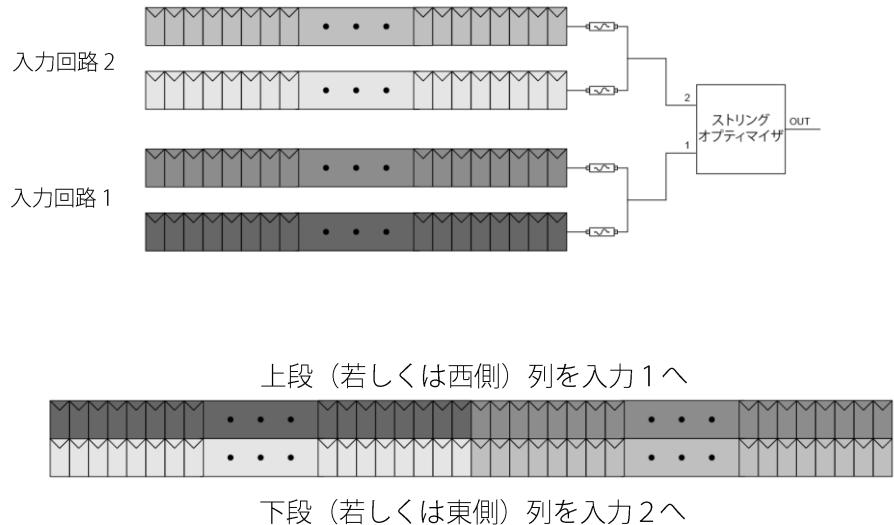
図 9: 発電量を最大化するために、同じ列のモジュールは同じオプティマイザ入力に接続してください。
