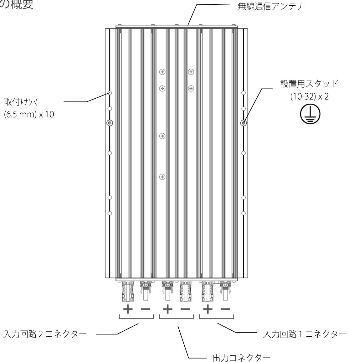
図 2: Ampt ストリングオプティマイザの各部の概要
