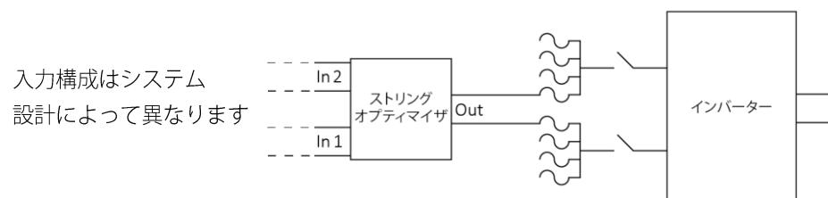
図4: 非接地 PV アレイの電気接続
