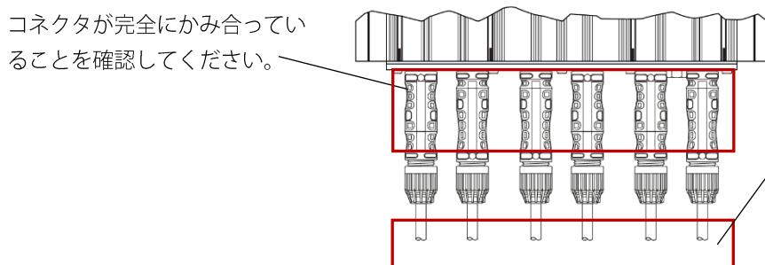
図 18: コネクタが完全にはめ込まれていることを確認し、コネクタに張力がかからないようにケーブルを整線します
