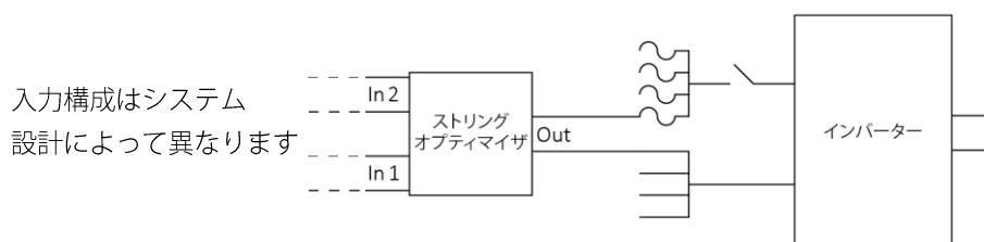
図5: 接地 PV アレイの電気接続
