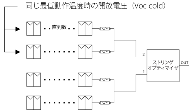
図6: 例—2ストリングスを並列して各入力回路に接続
