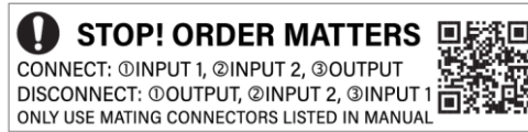
図 12: オプティマイザ前面フェイスプレートにある接続順序のラベル
